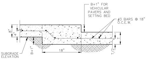
LONGITUDINAL SECTION AT DROP SLAB
